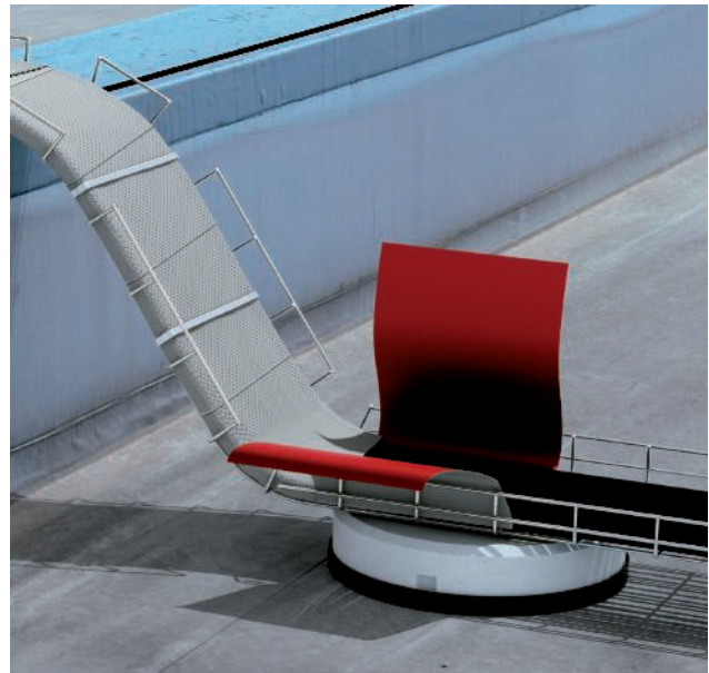
Brandschutzbandage zur Verhinderung der Brandübertragung
